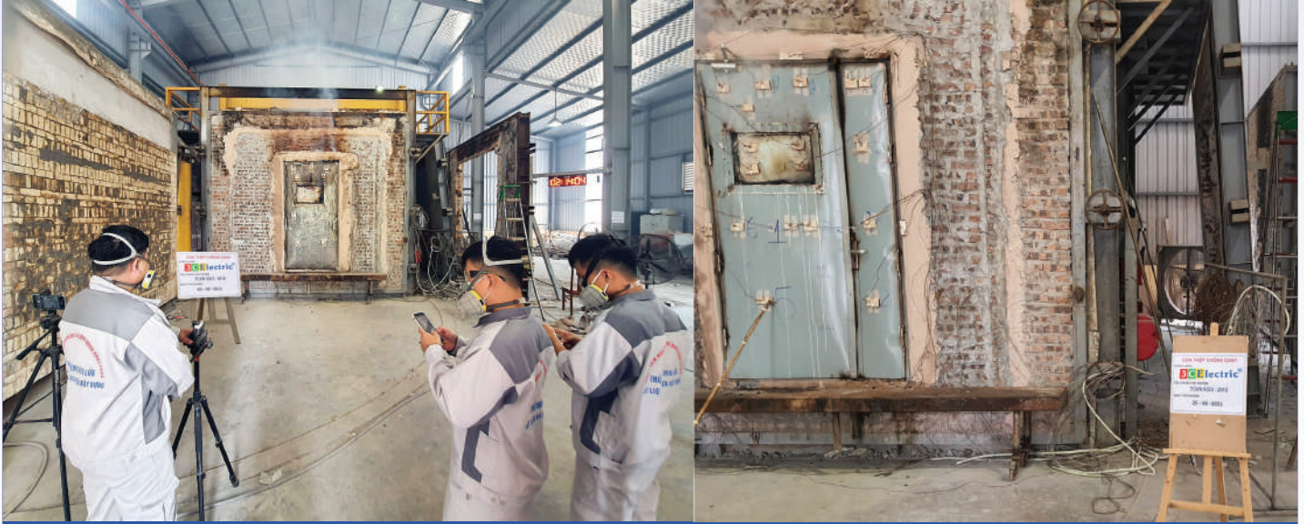
Hình ảnh đốt mẫu thử nghiệm cửa ngăn cháy 3CElectric
